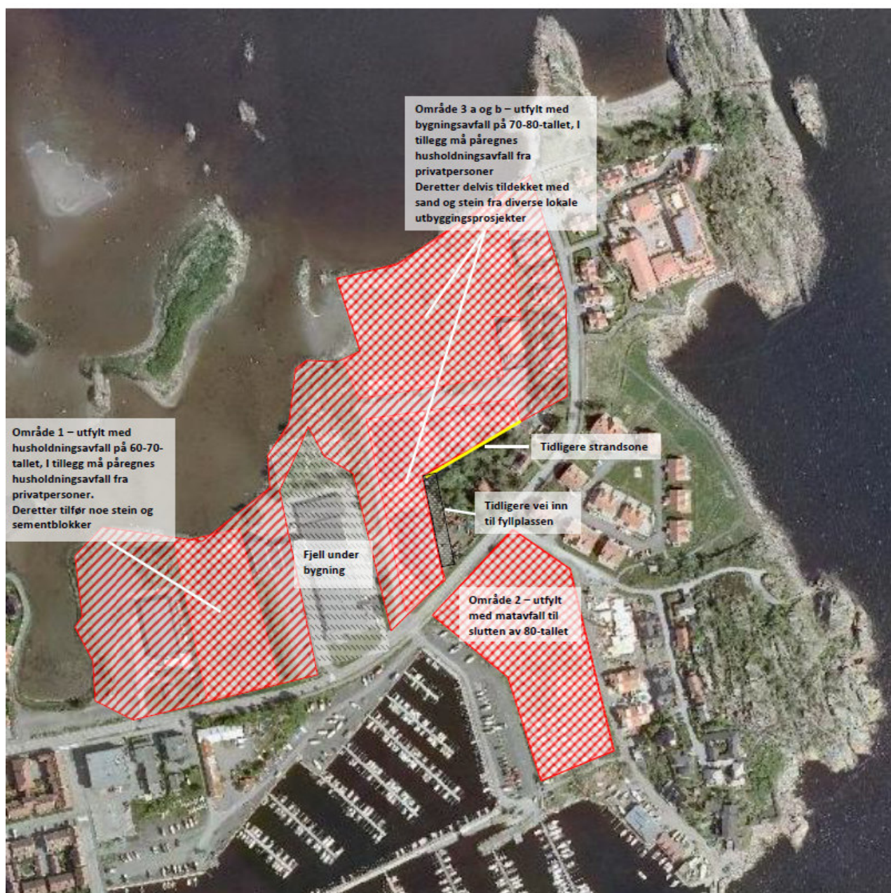
Figur 16 Bukta Stavern – antatt utbredelsen av fyllingen og avmerking av undersøkte områder.
